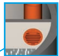
Kappe zur Verhinderung des Überschwimmens der Aufwuchskörper in die Vorklärung
