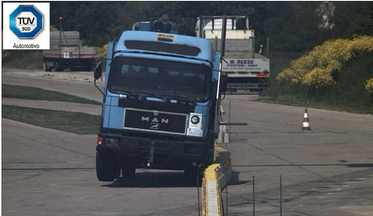
Bild: TÜV Süd Automotive GmbH, Anprallprüfung TB 41 gemäß DIN EN 1317-2 (LKW, 10.000kg, 70 km/h, 8° Anprallwinkel)
